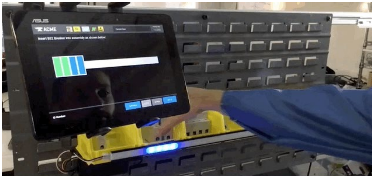
Korzystanie z systemu pick-by-light w celu naprowadzenia operatora do właściwych pojemników
